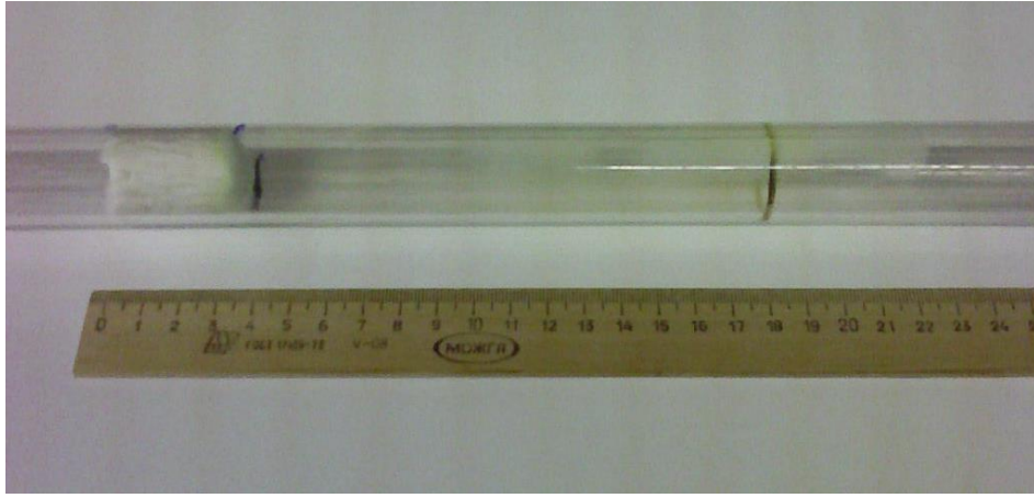
Рисунок 44 – Кварцевая трубка-холодильник с тампоном для улавливания \text{MoO}_3
