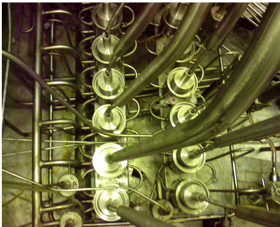
Рисунок 30 – Первый и второй блоки экстракционного каскада (вид сверху)
