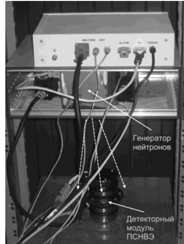
Рис. 4. Размещение экспериментального оборудования при калибровке нейтронами с энергией 14 МэВ.
