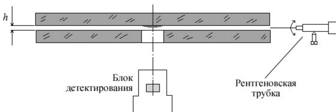
Рис. 14. Схема анализатора с ПВО.
