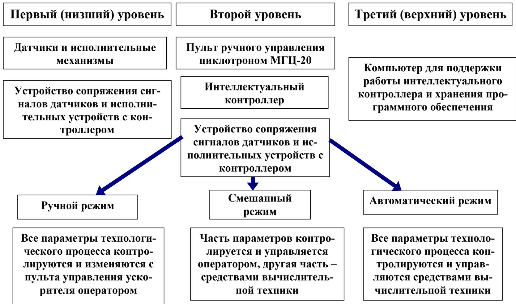
Рис. 5. Система автоматического управления циклотроном МГЦ-20 (схема).
