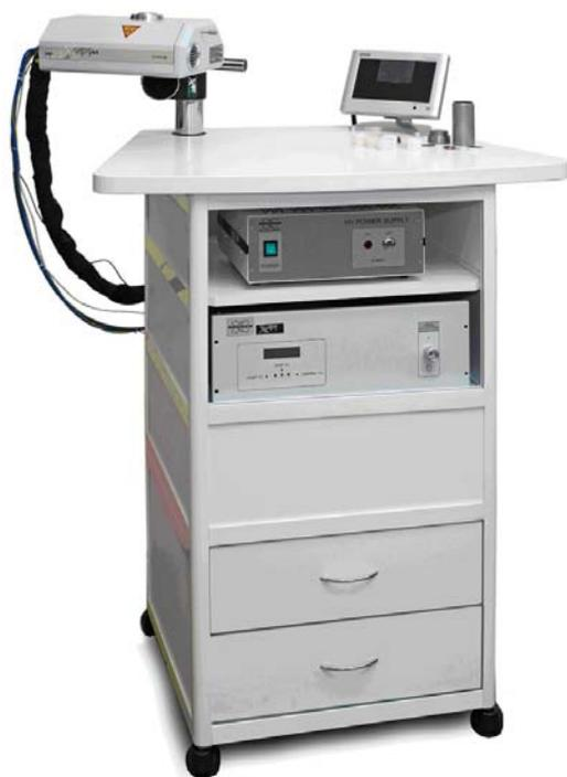
Рис. 1. Общий вид анализатора X-Арт М. На столе стойки расположены: аналитический блок, который произвольно разворачивается в пространстве и передвигается вертикально на опоре с воздушным тормозом, и монитор с точным прицелом, указывающим область наблюдения. Ниже расположены: блок питания и управления системой возбуждения и спектрометрический тракт анализатора.
